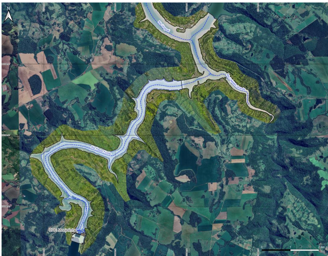
Figura 5 – Trecho de inundação a jusante da UHE Monjolinho – Cenário Dia Seco ( Q_{MLT} ). Envoltória de Ruptura (linha preta) e cheia natural (linha pontilhada azul).
