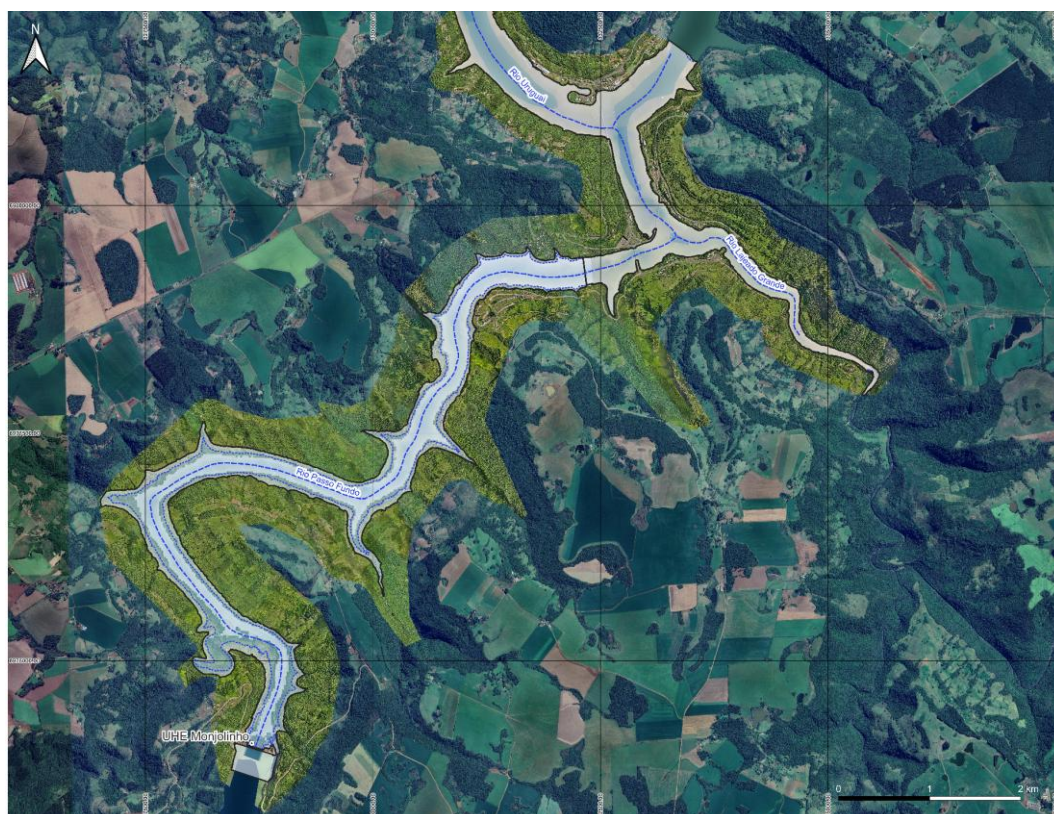
Figura 6 – Trecho de inundação a jusante da UHE Monjolinho – Cenário Dia Chuvoso (TR 10.000 anos). Envoltória de Ruptura (linha preta) e cheia natural (linha pontilhada azul).
